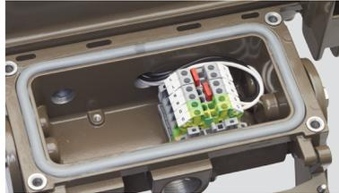
Compartimiento de cableado en frontal con juntas, bloque de terminales tipo tornillo, apertura con bisagra fácil de traccionar y tornillos cautivos
