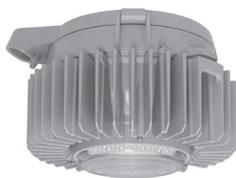
La conception de l'enveloppe du driver à LED comprend des sections séparées pour le bornier et le driver à LED. La conception thermique efficace garantit un transfert de chaleur fiable des LED vers l'extérieur, par l'intermédiaire du dissipateur thermique et du corps en aluminium moulé avec revêtement en peinture époxy grise.
