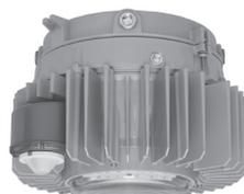
La conception du boîtier du pilote comprend des sections séparées pour le bornier et le pilote. La conception thermique efficace assure un transfert de chaleur fiable depuis l'ensemble LED vers l'extérieur via le radiateur et le boîtier moulé en aluminium avec revêtement en poudre d'époxy.
