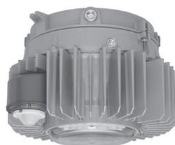
La conception de l'enveloppe du driver intègre des compartiments distincts pour le bornier et le driver. La conception thermique efficace garantit un transfert de chaleur fiable des LED vers l'extérieur, par l'intermédiaire du dissipateur thermique et du corps en aluminium moulé avec revêtement en peinture époxy grise.
