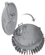
Système de verrouillage et charnière : le système de verrouillage imperdable en acier inoxydable (boulon et écrou) se ferme en toute sécurité et résiste aux atmosphères corrosives. La conception escamotable simplifie le câblage et l'installation. La charnière extra haute offre une protection supplémentaire contre le détachement accidentel de l'enveloppe du driver à LED lors de l'installation ou de l'entretien.
