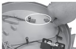
Un simple connecteur à déconnexion rapide permet de couper l'alimentation entre les LED et le module de gestion de la batterie pour faciliter l'entretien dans les zones dangereuses.
