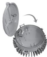
**Système de verrouillage et charnière** : le système de verrouillage imperdable en acier inoxydable (boulon et écrou) se ferme en toute sécurité et résiste aux atmosphères corrosives. La conception escamotable simplifie le câblage et l'installation. Une charnière extra haute offre une protection supplémentaire contre le détachement accidentel de l'enveloppe du driver lors de l'installation ou de la maintenance.
