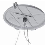
Le capot suspendu étanche assure une protection contre l'infiltration d'eau dans le conduit à l'aide d'un réducteur de tension conforme à l'indice IP68 avec 3 trous de câble de 4 mm (0,157 po) de diamètre.
