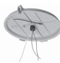
Le capot suspendu étanche assure une protection contre l'infiltration d'eau dans le conduit à l'aide d'un réducteur de tension conforme à l'indice IP68 avec 3 trous de câble de 4 mm (0,157 po) de diamètre.
