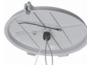
**Capot suspendu étanche :** assure une protection contre l'infiltration d'eau dans le conduit à l'aide d'un réducteur de tension conforme à l'indice IP68 avec trois trous de câble de 4 mm (0,157 po) de diamètre.
