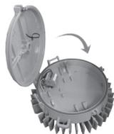
**Système de verrouillage et charnière** : le système de verrouillage imperdable en acier inoxydable (vis et écrou) se ferme en toute sécurité et résiste aux atmosphères corrosives. La conception escamotable simplifie le câblage et l'installation. Une charnière extra haute offre une protection supplémentaire contre le détachement accidentel du boîtier du pilote lors de l'installation ou de la maintenance.
