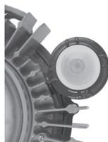
Grâce à la détection infrarouge passive (PIR), le Mercmaster connecté peut détecter des objets de taille humaine à une distance maximale de 12 mètres. Le Mercmaster connecté offre deux choix d'optiques PIR de Fresnel infrarouges passives en fonction de la hauteur de montage pour optimiser les performances de détection.
