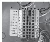
**Paramétrage de la batterie modifiable sur le terrain :** Permet à l'utilisateur de changer le réglage de la batterie au besoin de 90 à 180 min et vice-versa.
